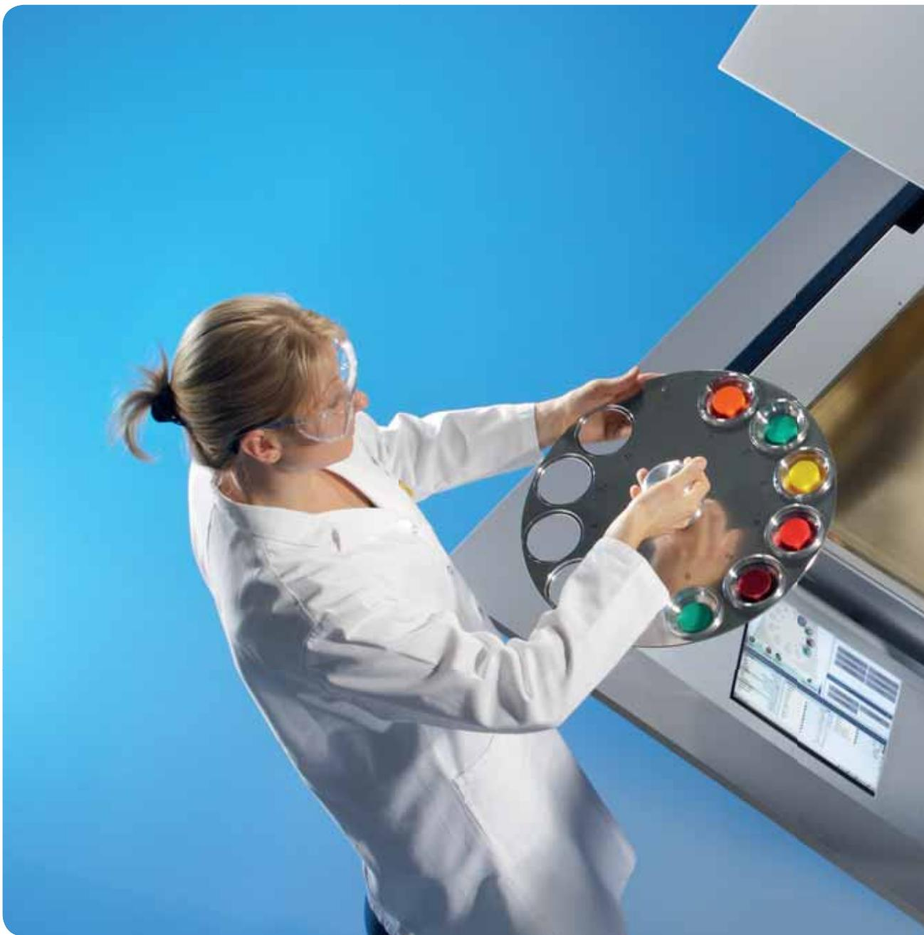
Быстрая загрузка целых партий или крупных образцов с помощью спектрометра S2 PUMA Carousel
