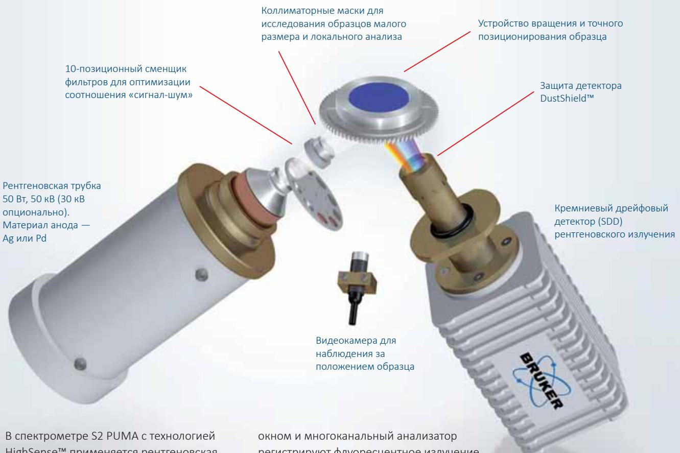
В спектрометре S2 PUMA с технологией HighSense™ применяется рентгеновская трубка мощностью 50 Вт с торцевым окном, непосредственно возбуждающая рентгеновскую флуоресценцию образца. Энергия возбуждения регулируется величиной ускоряющего напряжения рентгеновской трубки и выбором материала фильтра. Детектор с тонким
