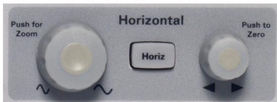
Рис. 4 Элементы управления разверткой (по оси X) осциллографа
